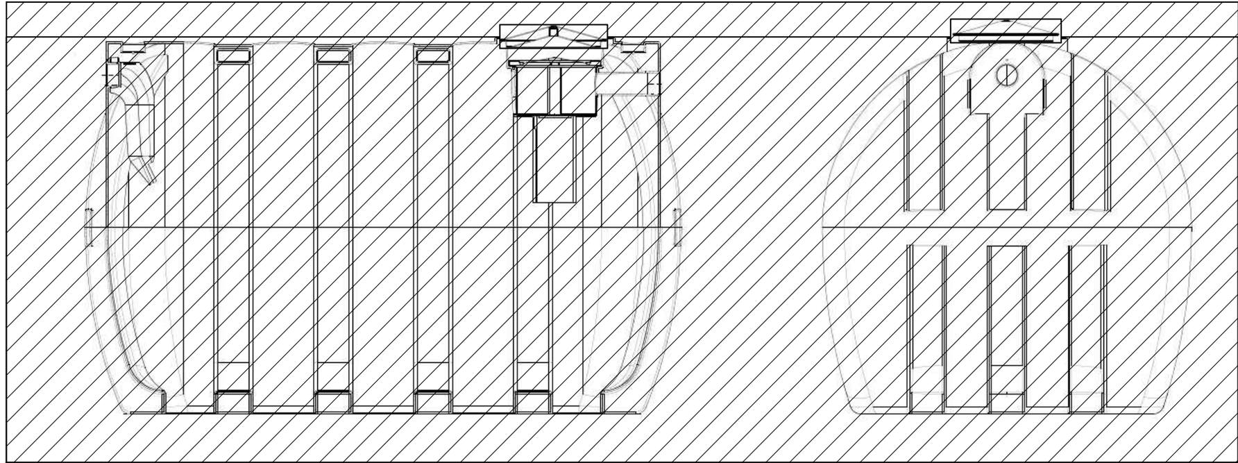
Les ouvrages FAN (fosse) et CAN (cuve) doivent impérativement être enterrés sur toute la hauteur.
