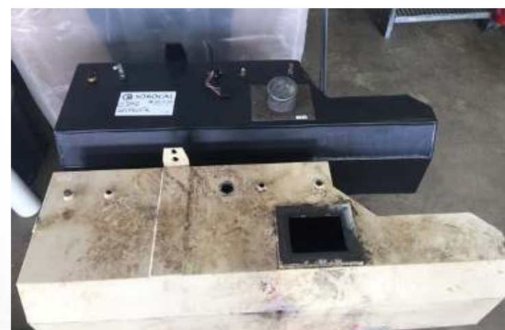
Avant/Après de reproduction de réservoir à gasoil
