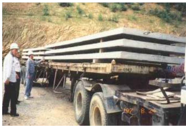
Figure 55. Voiles béton avec l'étanchéité
