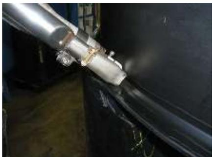
4. Soudure par extrusion de matière en fusion afin de donner la résistance mécanique et une étanchéité optimale.
